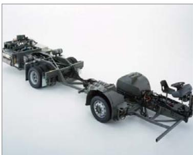
**Chasis:** armazón del vehículo, que comprende el bastidor, ruedas, transmisión con o sin motor, excluida la carrocería y todos los accesorios necesarios para acomodar al conductor, pasajeros o carga.
