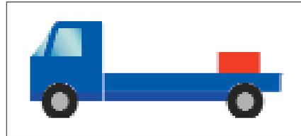
Colocación correcta: Colocar la carga algo adelantada respecto al eje posterior, con la cara de mayor dimensión sobre la caja.
