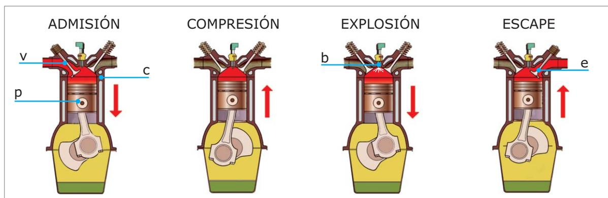
El movimiento del pistón es lineal (de arriba a abajo y viceversa) el cual se transforma en circular (rotatorio de las ruedas) por el mecanismo biela-cigüeñal.
