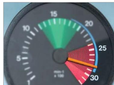
En retención, el motor se pasa de revoluciones cuando supera un régimen próximo a la zona peligrosa sin acelerar, al variar la relación del cambio de marchas (reduciendo) para, por ejemplo, hacer uso del freno motor a plena potencia de frenado. Si el empuje del vehículo es superior a la capacidad de retención del freno motor, las revoluciones aumentan y se entra en la zona peligrosa.
