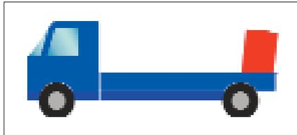
Colocación incorrecta: Se puede arquear el bastidor. Sobrecarga las ruedas traseras, desgastándolas en exceso.
