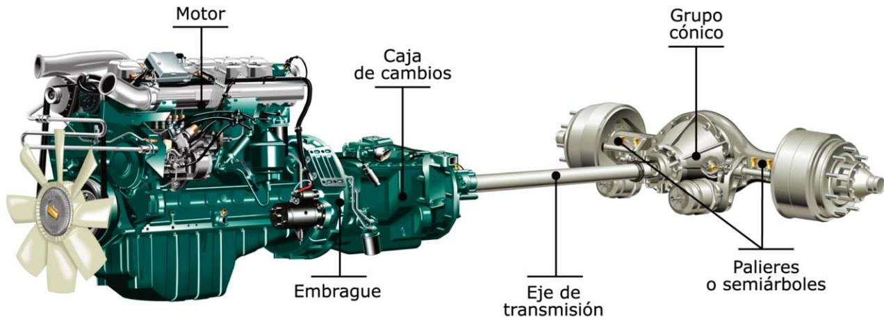
La misión del árbol de transmisión es transmitir la fuerza y el movimiento desde la salida de la caja de cambios hasta el grupo cónico-diferencial, cuando es necesario cubrir la distancia entre el motor y el eje motriz.
