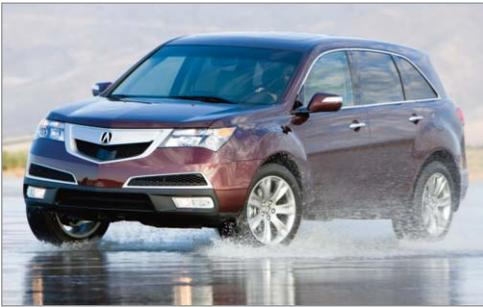
*Aquaplaning.* Es una situación en la que la rueda flota sobre el agua. Suele deberse a una velocidad excesiva o al mal estado de los neumáticos, ya que éstos no pueden desalojar el agua que hay en la calzada a través del dibujo de la banda de rodadura.
