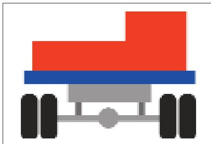
Colocación incorrecta: Frenada desigual. Desgaste desigual de ruedas, ballestas y amortiguadores. Peligro de patinazo.
