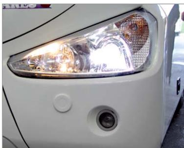
**Luz alta:** luz proyectada por los focos delanteros del vehículo en forma paralela a la calzada, cuya potencia permite visualizar obstáculos a una distancia no inferior a 150 metros.
