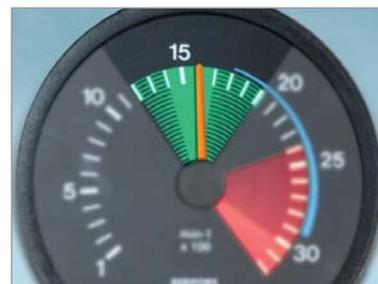
**Zona roja:** Indica la zona peligrosa, donde el motor puede resultar dañado por exceso de revoluciones. En el caso de la imagen, existe una zona sin color, entre 2.000 y 2.300 rpm, que indica que está cerca de la zona peligrosa. En esta zona se produce un aumento considerable del consumo.
