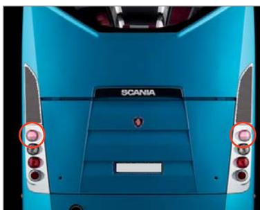
**Luz de estacionamiento:** luz continua o intermitente que permite identificar un vehículo estacionado.
