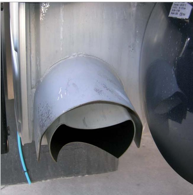
Este sistema recoge los gases quemados del motor y los expulsa al exterior, entre ellos, los más nocivos, el Monóxido de Carbono (CO) y el Óxido de Nitrógeno (NOx).
