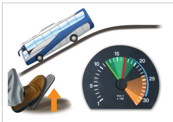
En determinados vehículos de última generación, si se ha fijado una relación con la botonera y las revoluciones aumentan por encima del límite de seguridad del motor, el sistema se protege pasando a una relación superior.
