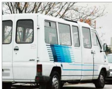
**Minibús:** bus de un piso de 12 a 17 asientos, incluyendo el del conductor.
