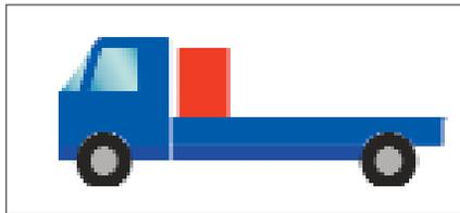
Colocación incorrecta: Se puede arquear el bastidor. Sobrecarga las ruedas delanteras, las desgasta y agarrota la dirección.
