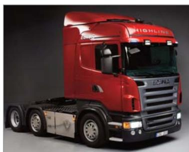
**Tractocamión:** vehículo a motor diseñado y equipado para arrastrar un semirremolque.
