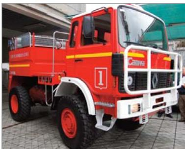
**Carro de bomberos:** vehículo de emergencia, diseñado para la extinción de incendios que cuenta con un estanque de agua y una bomba impulsora, además de equipos para el trabajo en incendios y rescate de personas.
