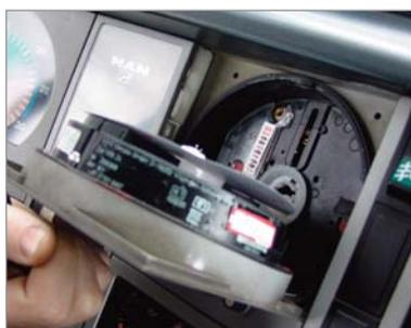
**Tacógrafo:** dispositivo que permite registrar datos generales de la marcha del vehículo, como velocidad, distancias recorridas y los tiempos de conducción y descanso del conductor.
