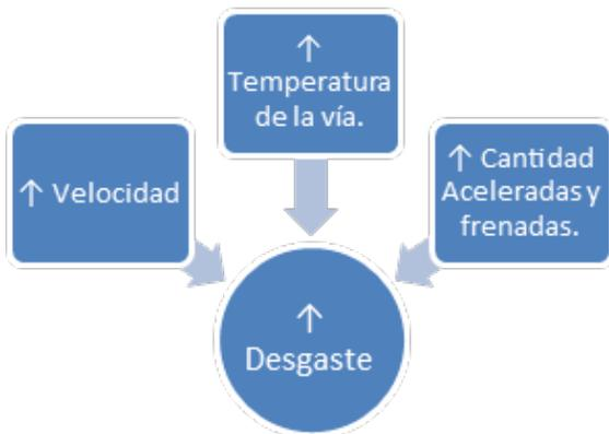
El desgaste depende de las condiciones de manejo: a mayor velocidad, mayor temperatura de la vía, o mayor cantidad (y brusquedad) de las aceleradas y frenadas, mayor desgaste. También es requerida una cierta temperatura de los neumáticos para su óptimo agarre, temperatura que generalmente se alcanza después de haber circulado unos minutos.
