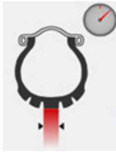
Sufrirá deformaciones excesivas en respuesta a los esfuerzos aplicados, lo cual puede llevar a una explosión. Le será más fácil detectar un neumático subinflado debido a que se manifiesta con la dirección pesada e inestabilidad de la moto (zigzaguo).
