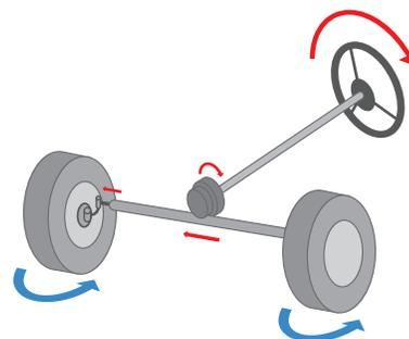
Muchos automóviles están equipados con servodirección. Éste consiste en un dispositivo hidráulico auxiliar que facilita el control de la dirección.
